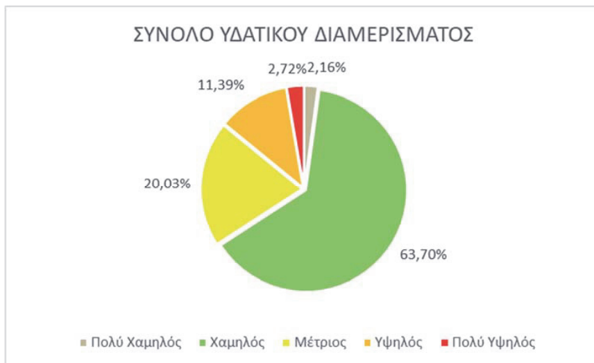
Εικόνα 8-11 Ποσοστό της συνολικής ζώνης κατάκλισης ανά κατηγορία τρωτότητας για το σύνολο του ΥΔ Θεσσαλίας
