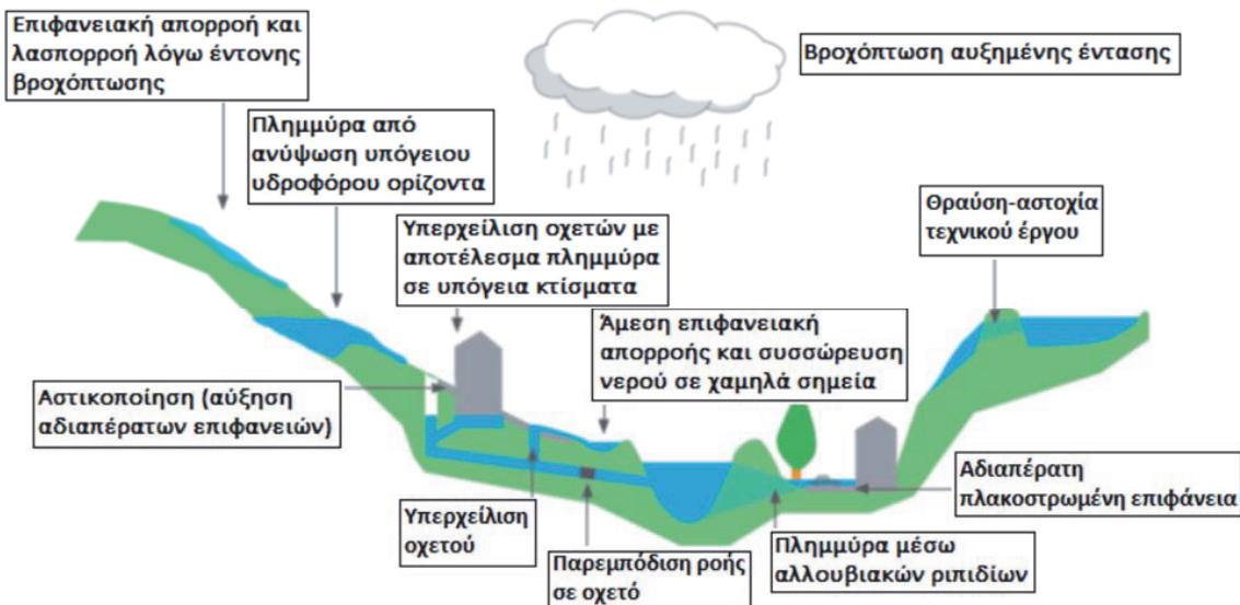
Εικόνα 5-3 Κύρια αίτια και τύποι πλημμυρών
