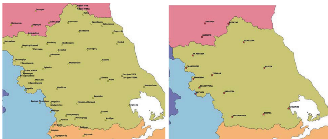
Εικόνα 7-2 Θέσεις Βροχομέτρων (αριστερά) και Βροχογράφων (δεξιά) που χρησιμοποιήθηκαν για την παραγωγή όμβριων καμπυλών στο ΥΔ Θεσσαλίας
