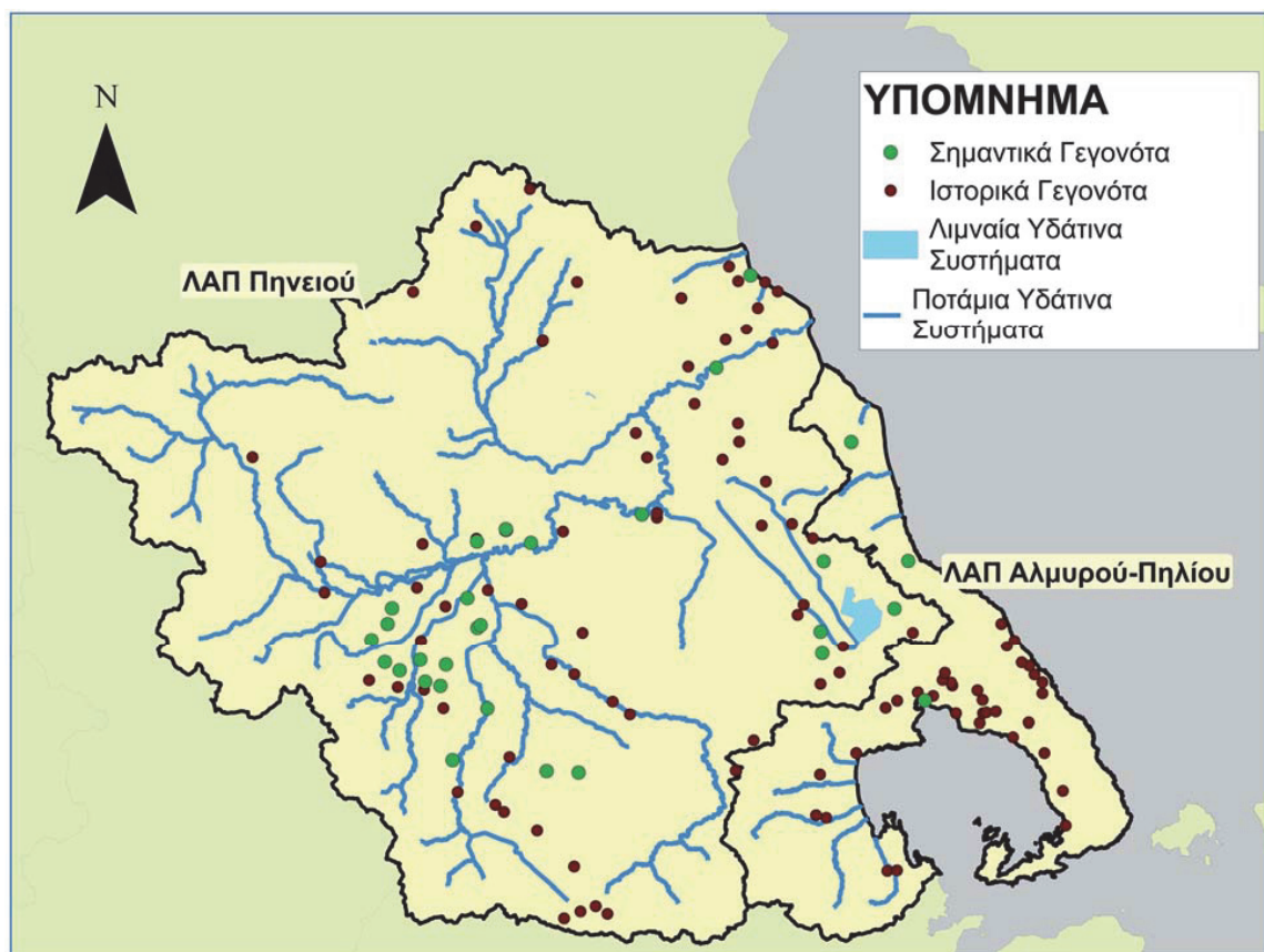
Εικόνα 5-1 Θέσεις Ιστορικών και Σημαντικών Πλημμυρικών Γεγονότων στο ΥΔ Θεσσαλίας
