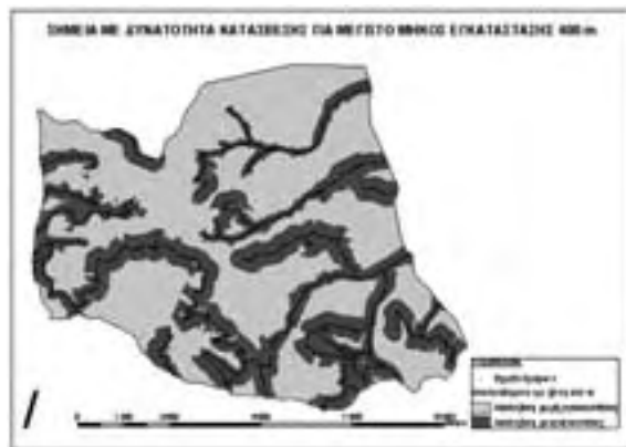
Σχήμα 5. Σημεία στα οποία είναι δυνατή η κατάσβεση με πυροσβεστικές εγκαταστάσεις και για μέγιστη, κεκλιμένη (προσαυξημένη κατά 20%) απόσταση από τον κοντινότερο οδικό άξονα 400 m Figure 5. Areas with 400 m maximum 3d distance from the nearest road, where forest fire suppression is possible by hoseline deployment
