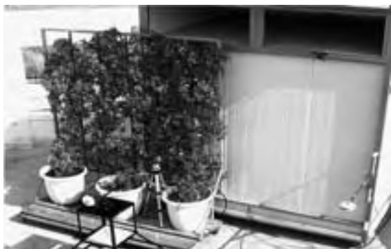
Σχήμα 3: Απεικόνιση του παθητικού στοιχείου αποτελούμενο από τον πειραματικό θάλαμο και τα αναρριχώμενα φυτά.
