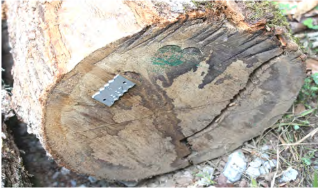
Εικόνα 2. Εμφάνιση πολλαπλών δεικτών υποβάθμισης ποιότητας σε κορμοτεμάχιο.
