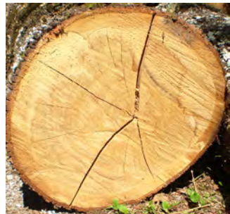
ε) Ραγάδαση. e) Crack.
