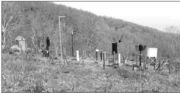
Εικόνα 4. Μετεωρολογικός σταθμός στην περιοχή μελέτης με ογκομετρικό βροχομέτρο μεγάλης χωρητικότητας (H=1.300 mm και D=440 mm) για τον έλεγχο της αξιοπιστίας των μετρήσεων άλλων παρακείμενων οργάνων Picture 4. Meteorological station in the study area equipped with a high capacity volumetric rain gauge (H=1,300 mm and D=440 mm) to check the validity of measurements of the adjacent instruments
