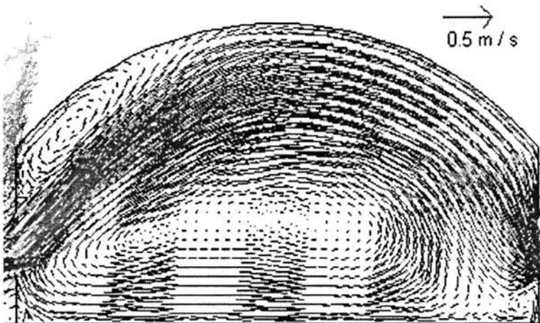
Σχήμα 3. Διανύσματα της ταχύτητας του αέρα για την δεύτερη περίπτωση.
