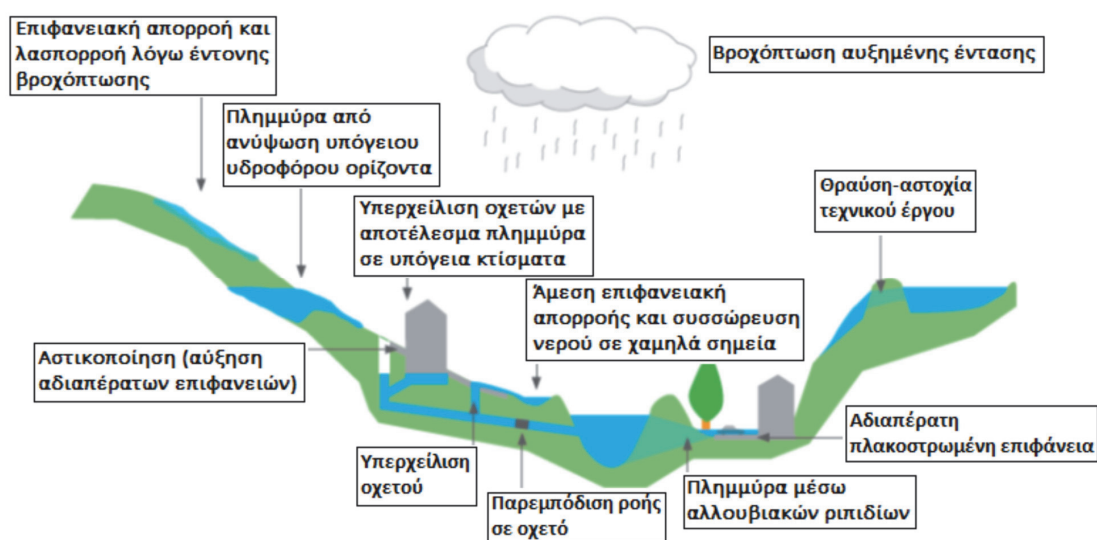
Εικόνα 5-3 Κύρια αίτια και τύποι πλημμυρών
