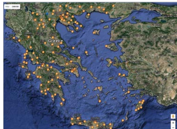
Εθνικό Δίκτυο Επιταχυνσιογράφων (σταθμοί της Διεύθυνσης Έρευνας Ι.Τ.Σ.Α.Κ. του Ο.Α.Σ.Π.)
