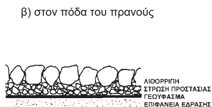
Σχήμα 3 - Στρώση προστασίας για τοποθέτηση μεγάλων ογκολίθων
