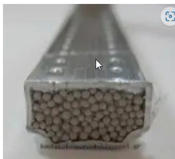
Εικόνα 1 - Τυπικός αποστάτης αλουμινίου γεμισμένος με πυριτικά άλατα
