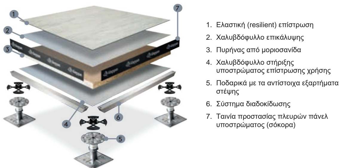
Σχήμα 1 - Συστατικά μέρη ενός υπερυψωμένου δαπέδου
