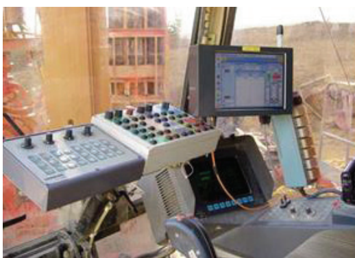
Εικόνα 4 - Ηλεκτρονικό σύστημα ελέγχου υδροφρέζας, με δυνατότητα περιορισμού των ανοχών κατακορύφωσης στο 0,3%
