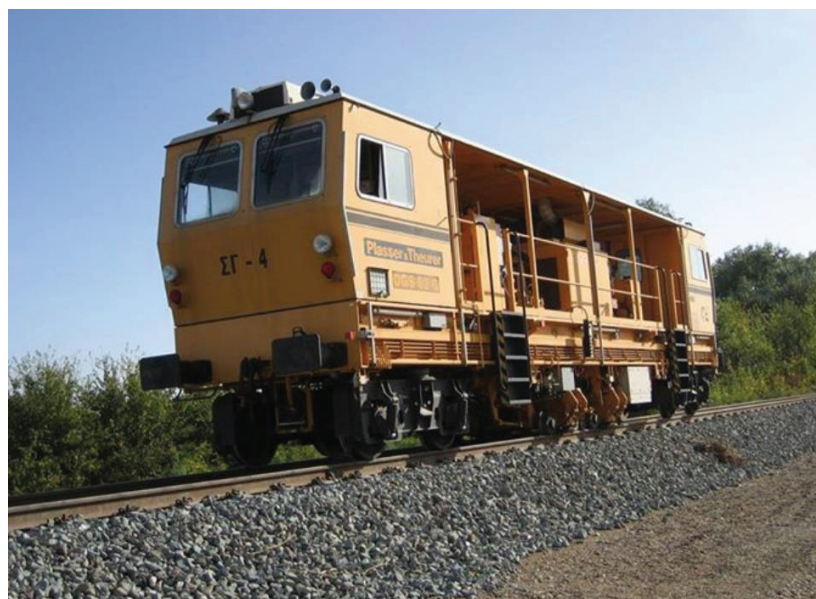
Εικόνα 3 - Δυναμικός σταθεροποιητής (σταμπιλιζάτορας) (dynamic track stabiliser)
