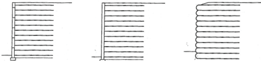
α) Διαμόρφωση μετώπου με συναρμολογούμενα στοιχεία
